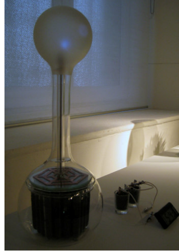
Soil Lamp, Soil Clock מאת: מריקה סטאפט מנורת לד ושעון אלקטרוני הפועלים על חשמל המופק מנחושת ואבץ המוכלים בתאי אדמה.
